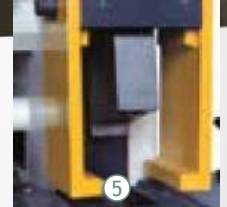
5 U çentik açma istasyonu U-notching station
