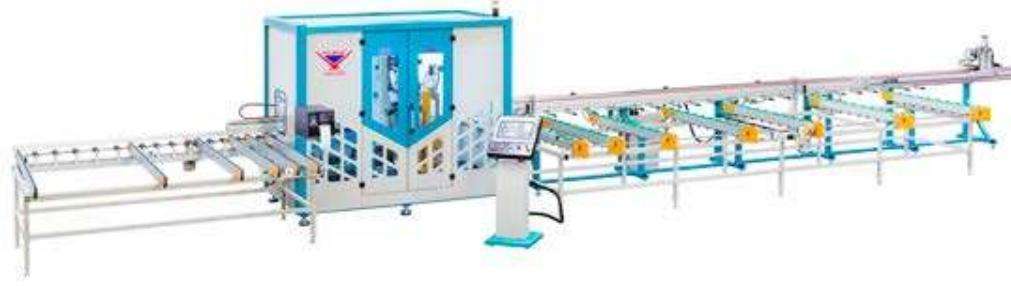
PIM 6508 est une machine à commande servo, assurant le mouvement sur 8 axes, conçue spécialement pour usiner tous les types de profilés en PVC utilisés dans le marché. Procéder à toutes les opérations de fraisage, d'ouverture des canaux de drainage, des trous d'emplacement de charnière, de clé et de poignée sur les quatre faces des profilés en PVC, coupe à la longueur par la scie. Le programme de la machine fonctionne selon le principe de déchets minimum et de production maximum.
