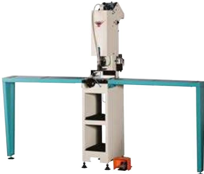
Utilisée pour visser d'une manière précise et rapide la tôle de support sur les profilés en PVC de portes et fenêtres.
