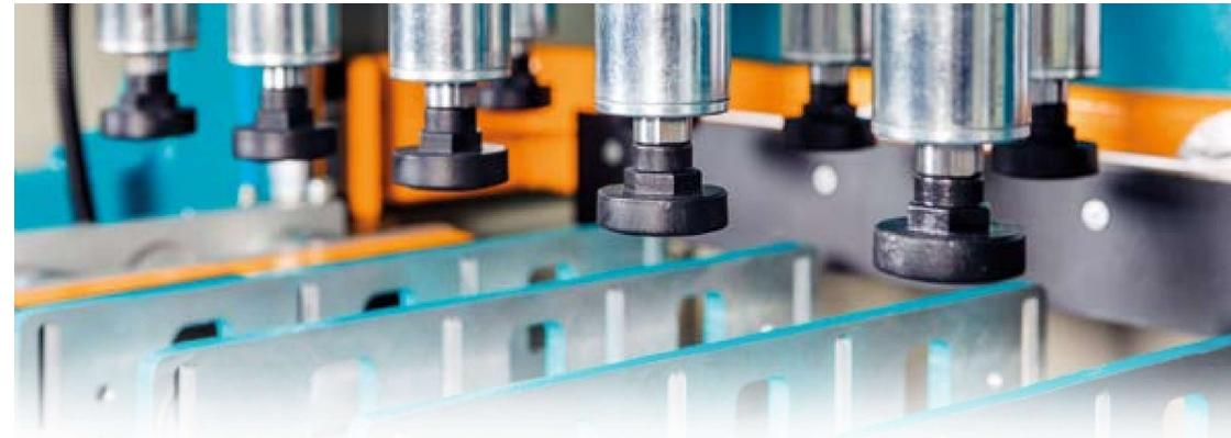
Machine d'entaillage de profilé multiple utilisée pour l'ajustage d'une manière précise des profilés en aluminium et PVC, fonctionnant en série avec mécanisme de courroie de moteur.
