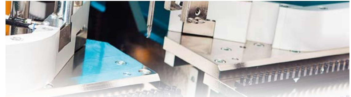
Ebavureuse à commande CNC qui nettoie les bavures survenues pendant le soudage des profilés en PVC soudés à 90° CNC 608: Option de 2x servomoteur, le CNC 610: Option de 4 x servomoteur
