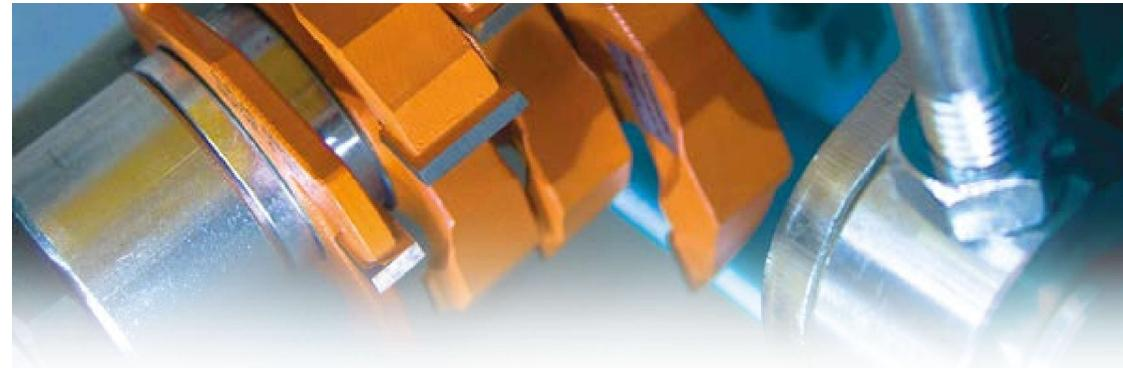
Ébavureuse d'angle manuelle CA 603 est une machine qui élimine les aspérités sur les surfaces supérieure et inférieure des profilés en PVC soudés à 90° et de leurs angles extérieurs.
