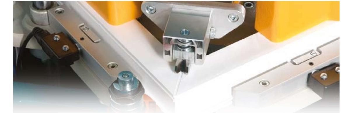
Ébavureuse d'angle manuelle CA 601 est une machine qui élimine les aspérités sur les surfaces supérieure et inférieure des profilés en PVC soudés à 90° et de leurs angles extérieurs.
