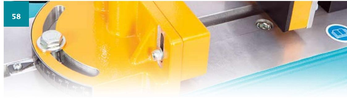
Machine d'entaillage au fonctionnement hydropneumatique, utilisée dans le processus d'ajustage précis des profilés en aluminium et PVC.
