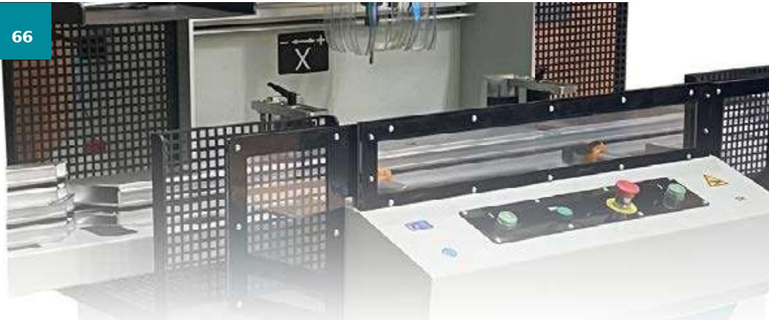
Le nouveau concept des routeurs de copie, ce routeur de copie à tête unique a la capacité de programmer les coordonnées X, Y, Z avec des moteurs asservis à 3 axes. Il est utilisé pour le traitement des fentes pour les serrures, les poignées de perçage, les charnières, les trous de crémone et l'ouverture de la fente d'évacuation d'eau sur les profils en PVC et en aluminium, cela signifie qu'il n'y a plus de gabarit.
