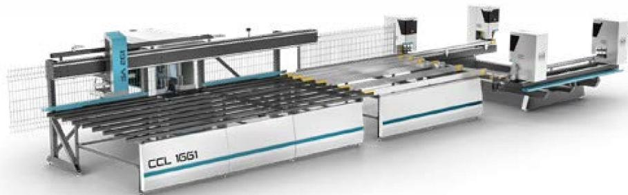
Il s'agit d'une ligne de nettoyage d'angles à commande numérique et de soudage de profilés en PVC à 4 angles qui permet un mouvement sur 2 et 4 axes. Après le soudage, le mécanisme du robot (SA 261) amène automatiquement le cadre du DK 541 à la station de refroidissement SA 251 et fait tourner le cadre vers la machine d'ébavurage (CNC 609 ou CNC 611).
