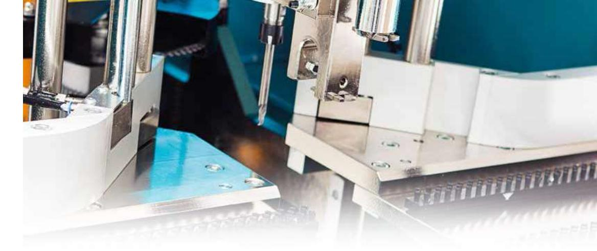
90° açı ile kaynatılmış PVC profillerin, kaynak sonrası oluşan çapakları temizleyen CNC kontrolü çapak alma makinesidir. CNC 608: 2x servo motor seçeneği, CNC 610 : 4x servo motor seçeneği
