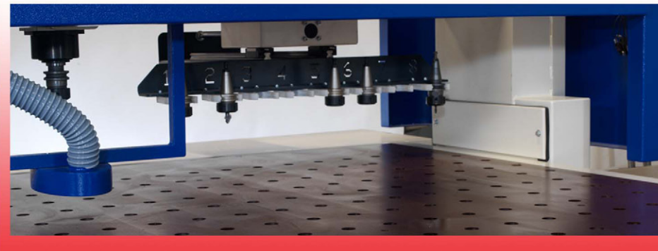
Cambio utensili a rientro automatico con otto stazioni
