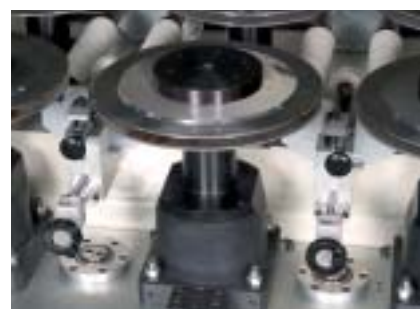
Rodillos suplementares ajustables por el soporte de los perfilados con formas particulares
